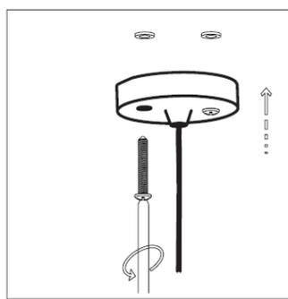
Befestigen Sie die Aufhängungen an der Leuchte. Der Sicherheitsverschluss muß geschlossen sein, sonst kann die Leuchte ggf. herunterfallen.
